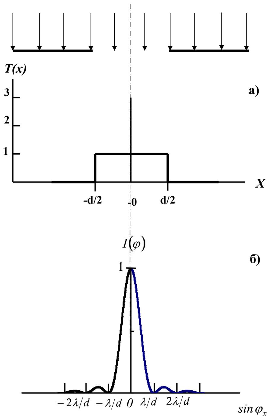
Рис.3.7. Функция пропускания одномерной щели шириной  $d$  по оси  $X$  - (а) и соответствующее распределение интенсивности на картине дифракции (Фраунгофера) в дальней зоне - (б).
