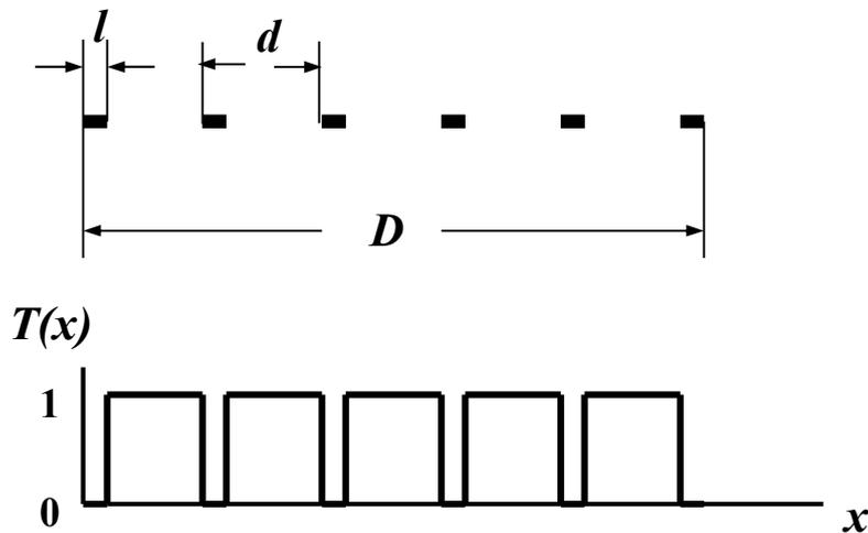
Рис.3.8. Функция пропускания одномерной дифракционной решетки
